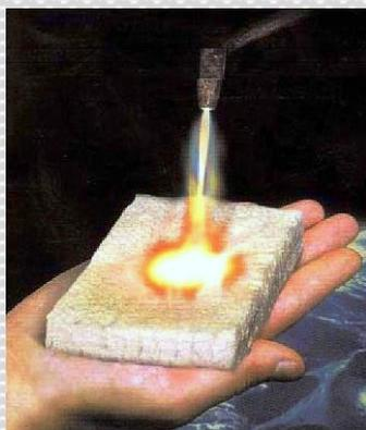
**Огнестойкие материалы премиум-класса SuperSilika полностью отвечают современным нормам "Технического регламента о требованиях пожарной безопасности" ФЗ № 123. Материалы содержат только кремнеземное волокно Ø 6-9 мкм. В процессе производства не допускается использование реконструированного и некондиционного волокна, а также включение обрывов нитки, ткани, пуха.**
